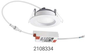
Einbauleuchte mit opaler Abdeckung (Diffusor). Hochwertiges Gehäuse, Leuchtenkörper aus Aluminium, weiß pulverbeschichtet (RAL 9003). Betriebsgerät: on/off (bereits im Lieferumfang enthalten).
