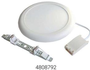
Ein-/ Anbaustrahler mit Flächenlicht, Gehäuse Kunststoff, inkl. Anschlussklemme für 230V mit integrierter Durchgangsverdrahtung, schnelle und einfache Montage durch verstellbare Federklemmen für Bohrungen von 65 bis 205 mm, dimmbar mit Phasendimmer
